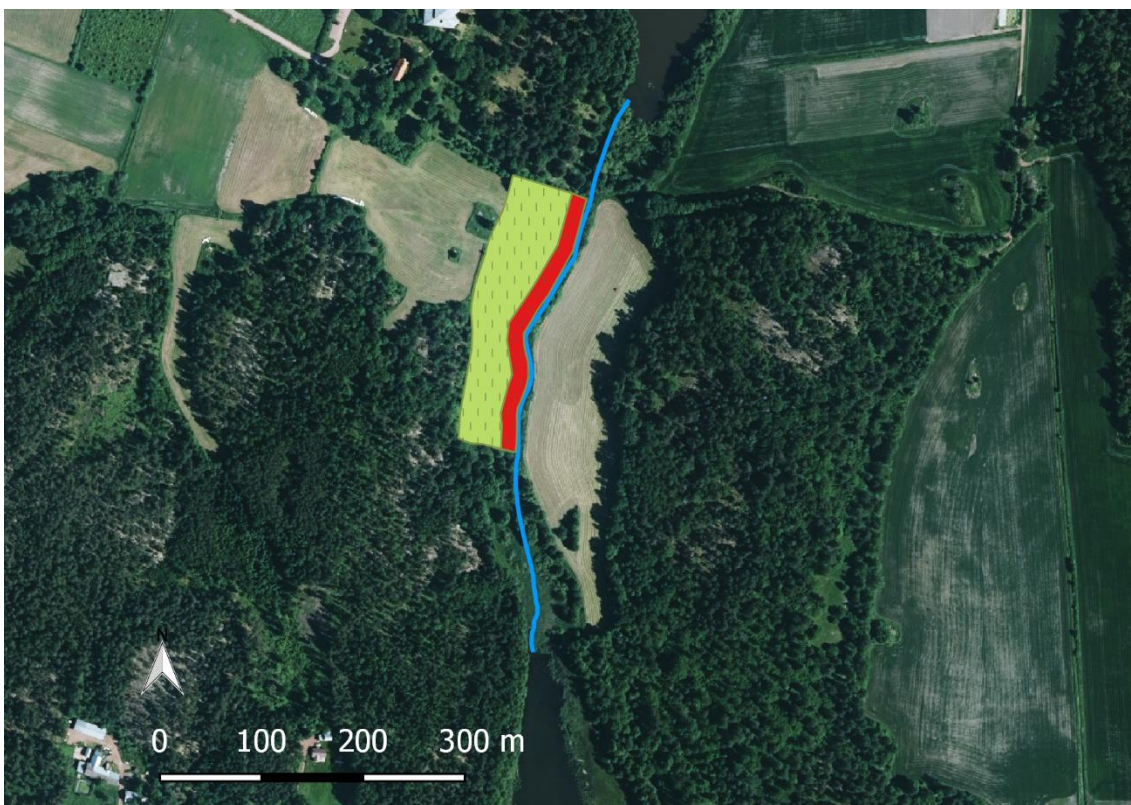
Bild 10. Skydds zoner som rekommenderas för åkern intill Prästräskets utfallsdike. Den primära rekommenderade skydds zonen är utmärkt med grönt och den minsta skydds zonen om 15 meter med rött. Innehåller material från Lantmäteriverkets terräng-databas 01/2018.
