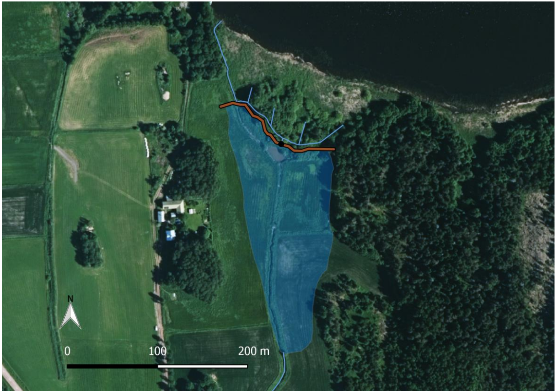
Bild 14. Genom dämning är det möjligt att bilda en sedimenteringsbassäng om 2 hektar i Strömmen. Med hjälp av ett kamdike kan vattnet avledas till det befintliga våtmarksområdet.
